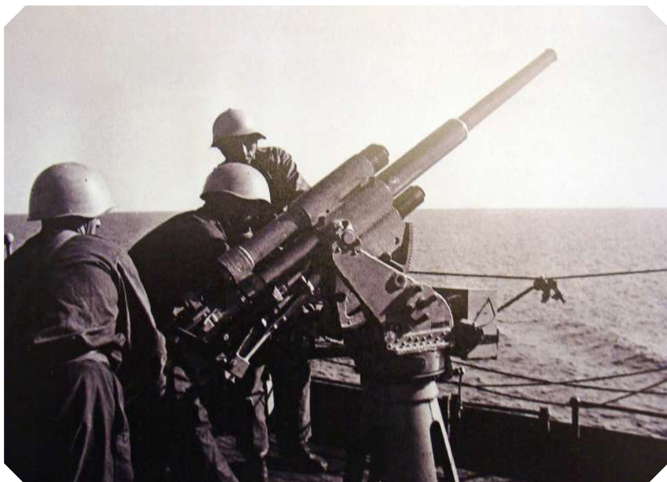
Фото 45. Расчёт 45/46-мм универсальной артиллерийской установки 21-К санитарного транспорта «Абхазия» в боевой готовности». Фото Н. Аснина. Такие же зенитные установки стояли и на «Армении»
